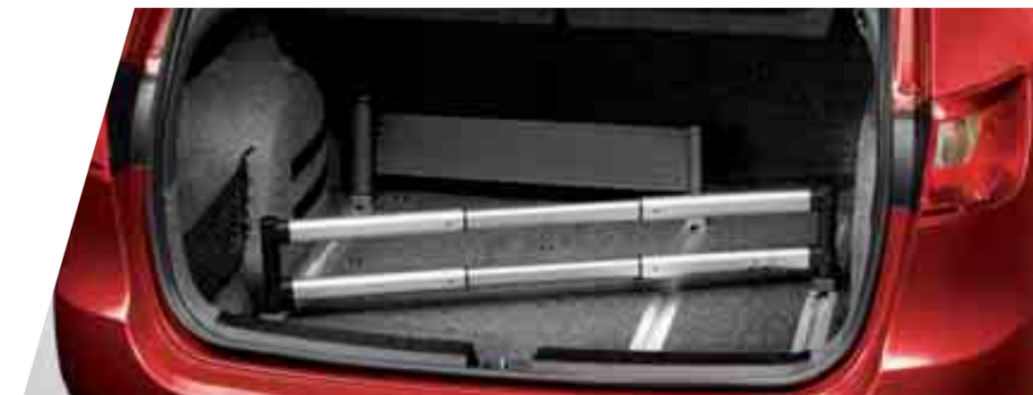
SOLUCIONES DE CARGA DE LA CAJUELA. El kit de accesorios para organizar la carga en la cajuela se compone de una base con carriles de guía, marco ajustable y separador flexible. 6J0061205
